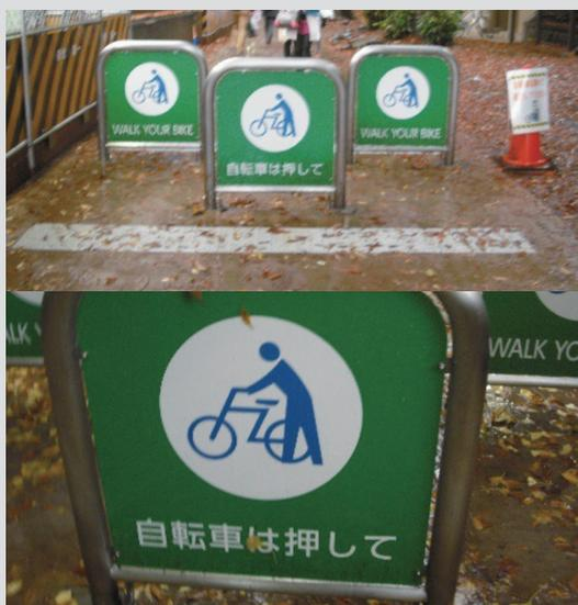
歩道に自転車の速度制限のための車止めが数か所設置され、車イスで通過しにくくなっている。
