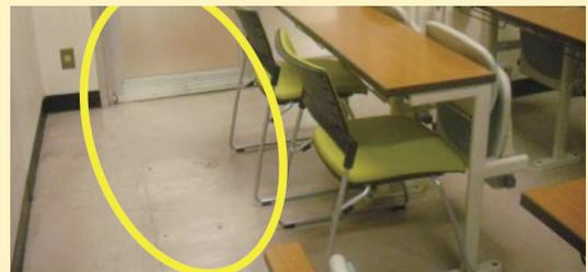
**改善例** 車イスでアクセスしやすい位置の固定式机と椅子の一部を撤去し、可動式の机と椅子を設置することで、車イス使用者が利用できるようにした。
